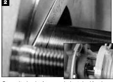
Consulte las imágenes de instalación de la página 2 para conocer los puntos de referencia a partir de los cuales medirá la dimensión de instalación. Rocíe el eje en el área del punto de referencia con tinta para metales y marque el punto.
