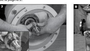
Aplique una película delgada de grasa al O-Ring del eje y deslice la unidad rotatoria sobre el eje de modo que la parte posterior de la unidad quede alineada con la marca de trazado medida. Apriete todos los tornillos de fijación de manera uniforme.
